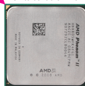
Unité centrale AM3
