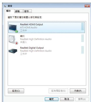
在Windows Vista进入此选单，请在开始>控制面板>声音及音频信号设备>音频信号，将「Realtek HDMI Output」设为预设值。
