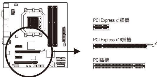
请依下列步骤将适配卡正确地安装于主板的适配卡插槽内:
