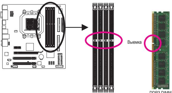
На печатной плате любого модуля ОЗУ DDR3 присутствует специальная выемка, которая облегчает процедуру инсталляции. Приведенное далее пошаговое руководство поможет корректно установить модули в соответствующие DIMM-разъемы на системной плате.
