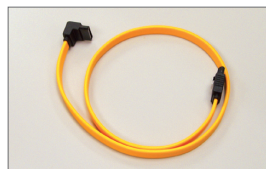
Końcówkę kabla SATA 3Gb/s (w kształcie litery L) podłączyć do dysku twardego SATA.
