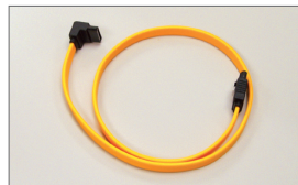
Collegare il terminale a forma di L del cavo SATA 3Gb/s al disco rigido SATA.
