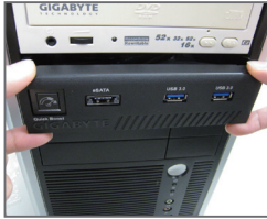
Hızlı Performans Arttırma Düğmesi Power eSATA Bağlantı noktası USB 3.0/2.0 Bağlantı noktaları
