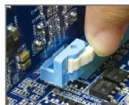
• 移除在PCIEX4插槽上的显卡:
