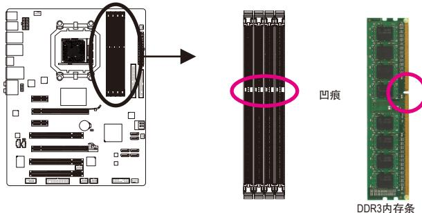
DDR3内存条上有一个凹痕，只能以一个方向安装至内存条插槽内。请依下列步骤将内存条正确地安装于主板的内存插槽内。
