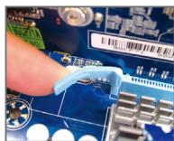
• 移除在PCIEX16插槽上的显卡:
