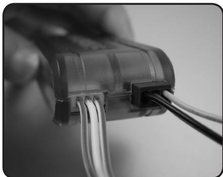
4-17-4 將所附之風扇調速盒電源線，連接至風扇調速盒上的接頭（如圖 a），電源線另一端插入風扇1轉2電源線的另一個空插頭（如圖 b），如此即安裝完成。
