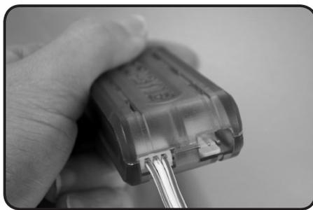
4-17-3 將散熱排上的風扇電源線插入風扇調速盒上的接頭。
