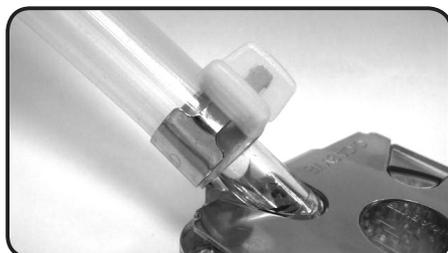
4-5-3 將 Tube2 依圖示一端接至 4 通止水閥 (2) B 接頭處，並將管夾套入夾緊。
