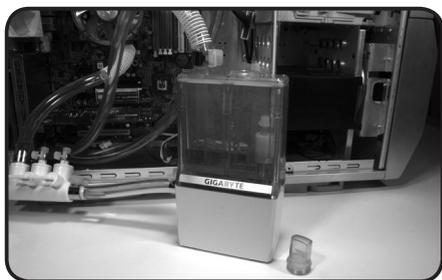
5-1-3 再次將水箱注水孔瓶蓋打開，注滿水冷液並將瓶蓋蓋上，再度重新啟動電源，重複此步驟直到水位高於低水位警示。
