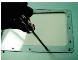
ステップ4:シースルー側面パネルを適切に設置し、ネジで回して取り付けを終了してください。
