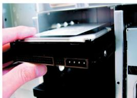
4-8-1 レールをHDD両側に均しく取り付けて、HDDをハードディスクドライブベイに差し込みます。
