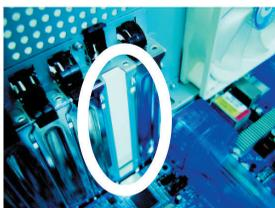
4-3-3 内部に装着されたPCIブラケットを取り外します。
