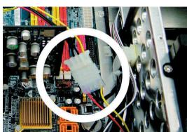
4-9-1 前面プロジェクタライトの4ピン電源ケーブルをマザーボードの4ピンコネクタに挿入します。
