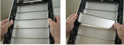
4-6-1 前面パネルを取り外し(7ページのステップ1-3-1参照)、5.25"の金属パネルを取り外します。
