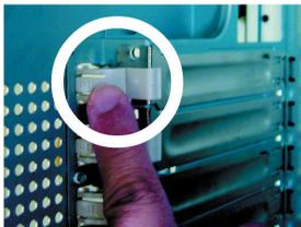
4-3-1 PCIソケットの固定留め具のロックを解除し、留め具を押し下げます。
