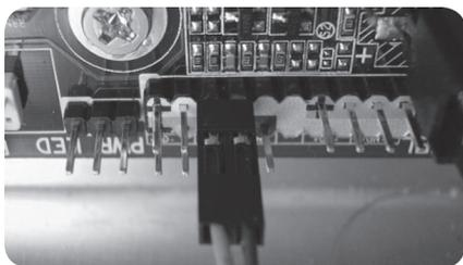
4-12-6-2 将泵浦上的4-pin接头接到电源供应器的4-pin接头上。
