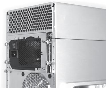
**4-1-6** 如果使用较长的电源供应器，请使用加长型电源供应器定位板，并使用加长型螺丝来加以固定。
