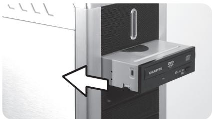
**4-6-3** 用内部卡榫将5.25"设备固定。安装程序如图所示。
