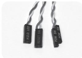
e. 电源开关/重开机开关/
