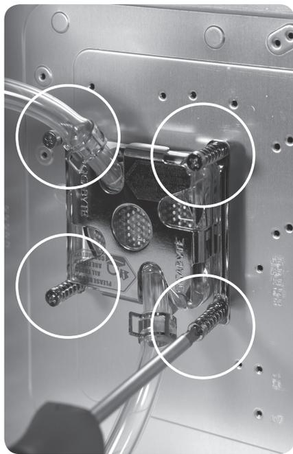
**4-2-2** 如果使用LGA775主板,请使用背板,并将CPU水冷头固定在主板后方。
