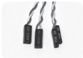
e. 電源スイッチ/リセットスイッチ /HDD用LEDコネクタ
