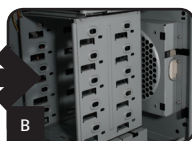
4-9.3 更换硬盘架上方的硬盘架变向固定扣，并将箭头对准想要的方向。(仅适用双向式硬盘架)
