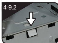
4-9.2 将可移动式硬盘架的免工具固定扣向下压并予以解开
