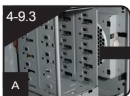
4-9.3 更换硬盘架上方的硬盘架变向固定扣，并将箭头对准想要的方向。(仅适用双向式硬盘架)
