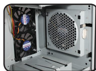
4-9.2 将可移动式硬盘架的免工具固定扣向下压并予以解开
