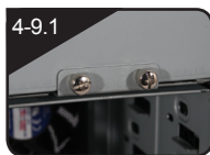
4-9.1 拆下固定可移动式硬盘架的指旋螺丝
