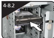
Das HDD in die Halterung einschieben und das HDD danach mit den Flügelschrauben befestigen.
