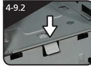
4-9.2 Die werkzeuggesteuernde Halterung der herausnehmbaren HDD-Halterung durch Niederdrücken entriegeln.
