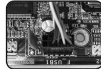
4-4.3 Den IEEE 1394-Anschluss in die entsprechende Fassung auf dem Motherboards einsetzen.
