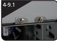
4-9.1 Die Flügelschraube entfernen, mit der die herausnehmbare HDD-Halterung befestigt wird.
