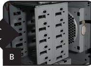
4-9.3 Changez la direction de la baie de disques durs en basculant le loquet supérieur de la baie et alignez les flèches sur la position désirée. (Double direction uniquement)
