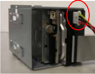
Fix the HDD cable to HDD 將硬碟機排線接至硬碟機
