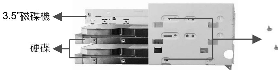
3. 接上附件盒內的 IDE 匯流排連接線，將黑色連接頭接於硬碟上，並將連接線上有標示紅色的第一腳對齊硬碟上標示 1 的腳位。
