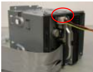
Fix the FDD cable to FDD 將軟碟機排線接至軟碟機
