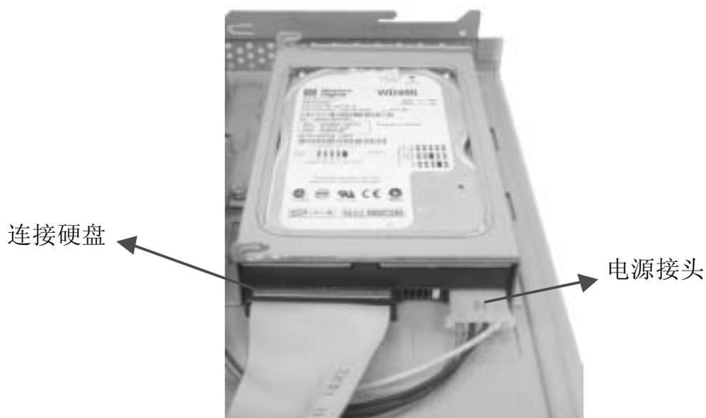
8. 完成以上组装动作后将硬盘支架再装回机箱中，并锁上螺丝。
